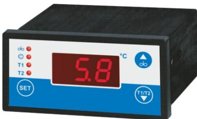
Der MPR-M2 ist ein mikroprozessorgesteuerter Milchtemperaturregler mit Nachrührautomatik. Er hat je einen Relaiskontakt für das Kompressorschütz und den Rührer. Die aktuell gemessene Milchtemperatur wird permanent auf dem Display angezeigt.
