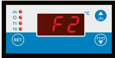
Fehler des Milchtemperaturreglers werden blinkend auf der LED -Anzeige angezeigt. Hierbei bedeuten:
